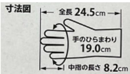
(左図) サイズMの寸法図
