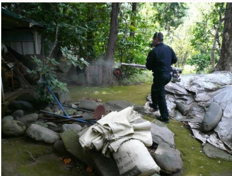
エンジン式なので電源が確保出来ない場所での施工に向いています。足元に障害物が多い現場でも、ホースなどが足に絡まず安全に作業が出来ます。
