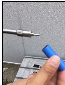
ノズル先端はかなり繊細なためぶつけ変形しないように十分注意する。
