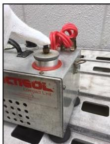
エア抜きボタンを押して、タンク内の圧力を抜く。
