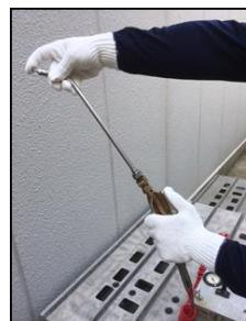
ノズルの先端を指で押さえながら、噴霧レバーを握り、ホースに残った薬剤をタンクに戻す
